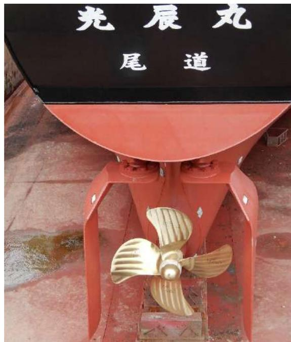
【船尾部】船尾部は、ゲートラダーを装備し、この舵の持つ操舵性能以外の推進性能をフルに活かせるような水流を得るために船尾バルブと言う膨らみをもたせた形状およびバトック船尾形状とした。
