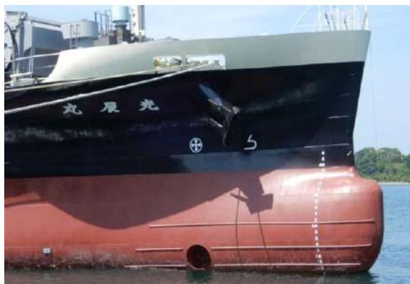
【船首部】ここ数十年建造された499GT型の船舶はバルバスバウが大きく突出している船型だが、本船はバウチョック先端からほぼ
