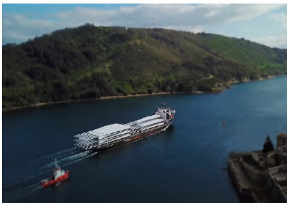
モジュール船によるブレード輸送 (ブレードの長さは、約 70 メートル)
