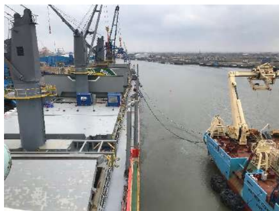
海底ケーブルの揚げ荷役風景 (左の船から右の船へ送り込む)
