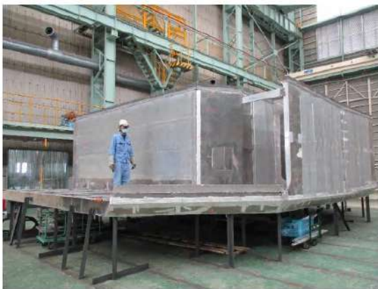
写真5 アルミ上構(居住区)ブロック[反転状態] (2022/6/16)
