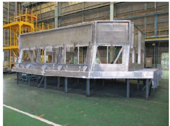
写真7 アルミ上構(操舵室)ブロック[反転状態] (2022/6/30)
